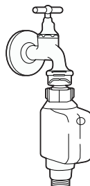
tuyau d'alimentation de sécurité
